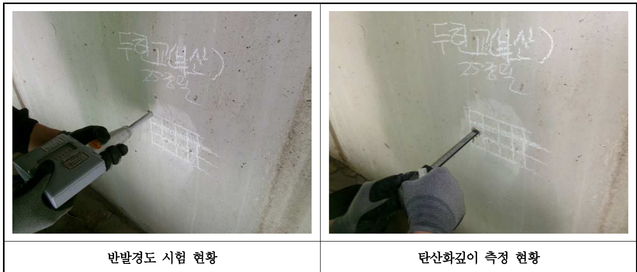
【사진 17.4.1】 콘크리트 내구성조사 현황
